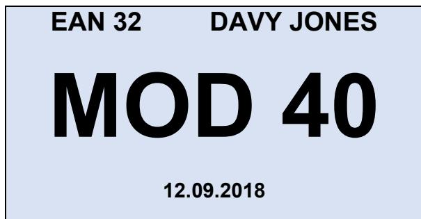
Для маркировки баллонов со смесью Nitrox дайвер IDU должен использовать следующий образец. Маркировка наносится в виде наклейки около вентиля баллона. На ней должны быть указаны следующие данные:
